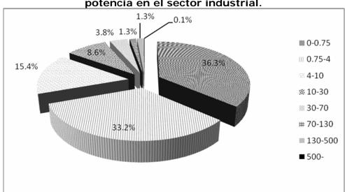
Figura 59. Distribución porcentual de motores eléctricos según su potencia en el sector industrial.
